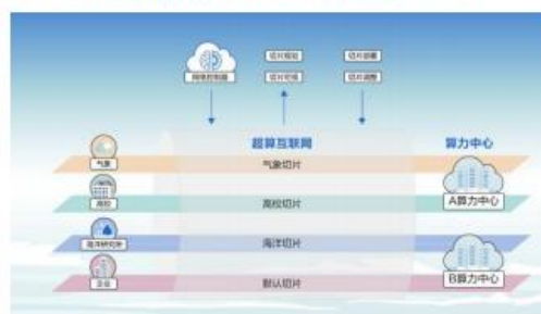
图 6: 网络切片确保算力网络的无损传输和安全隔离
